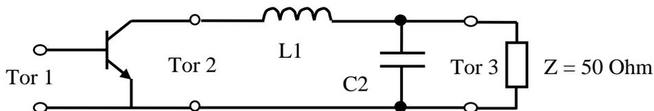
Entwickeln Sie mit Hilfe des beiliegenden Smith Diagramms die Ausgangsanpassung indem Sie für die Frequenz von 2.14GHz festlegen wie groß L1 und C2 sein müssen, damit am Tor 3 die maximale Leistung erreicht wird. Zeichnen Sie die Transformationswege, die L1 und C2 verursachen in das Smithdiagramm ein.
